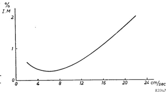
Fig. 31. Caratteristica d'intermodulazione di un pick-up magnetodinamico.
