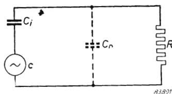
Fig. 19. Circuito equivalente del pick-up a cristallo.
