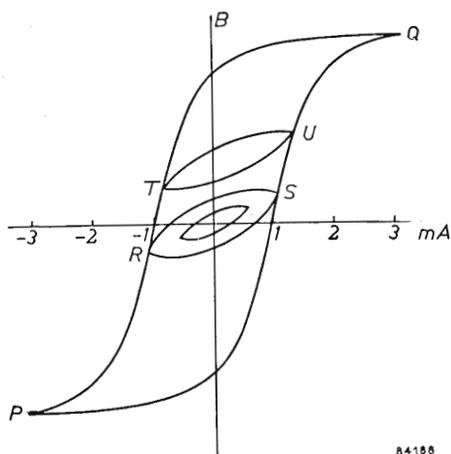
Fig. 107. Premagnetizzazione ad alta frequenza.
