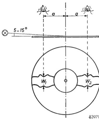
Fig. 102. Determinazione della larghezza della zona brillante sui dischi di frequenza.
