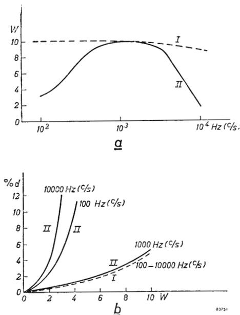
Fig. 56. Potenza e distorsione di due amplificatori differenti.
