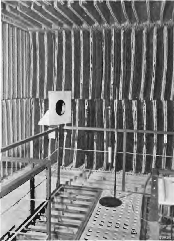
*Fig. 78. Camera silente per misure acustiche. Il microfono (sferico) è a destra dell'altoparlante; in questo caso l'altoparlante è montato su uno schermo acustico.*
