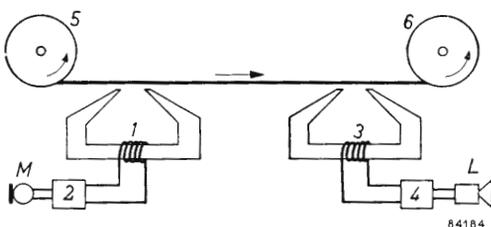
Fig. 104. Principio di funzionamento della registrazione magnetica.
