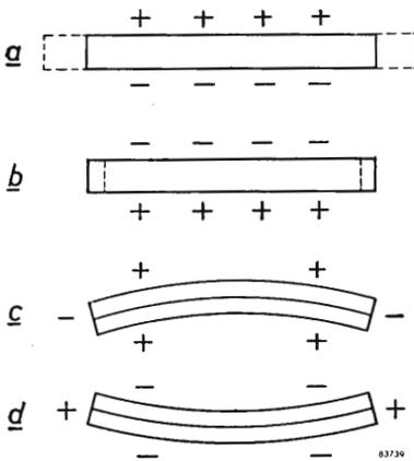
Fig. 17. Principio di funzionamento del pick-up a cristallo.
