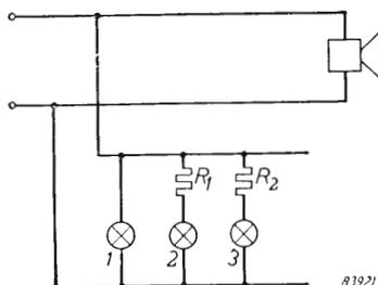
Fig. 99. Circuito per le misure della tensione d'uscita:
