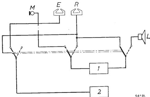
Fig. 109. Schema di principio di un registratore a nastro: *M* = microfono. *L* = altoparlante. *E* = testina di cancellazione. *R* = testina di registrazione e di riproduzione. *1* = amplificatore. *2* = oscillatore ad alta frequenza.
