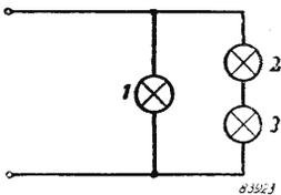
Fig. 101. Versione semplificata del circuito della figura 99.
