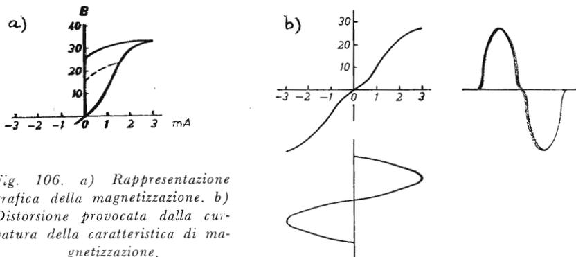
Fig. 106. a) Rappresentazione grafica della magnetizzazione. b) Distorsione provocata dalla curvatura della caratteristica di magnetizzazione.
