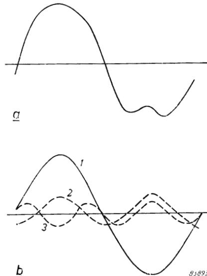
Fig. 30. a) *Vibrazione deformata.*
