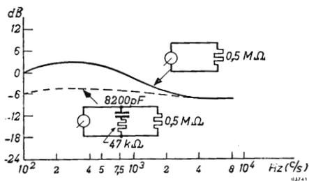
Fig. 26. Caratteristica di riproduzione del pick-up AG 3012.
