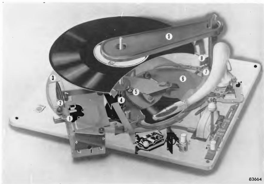
Fig. 54. Cambiadischi tipo AG 1000.
