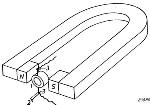
Fig. 22. Pick-up elettrodinamico.
