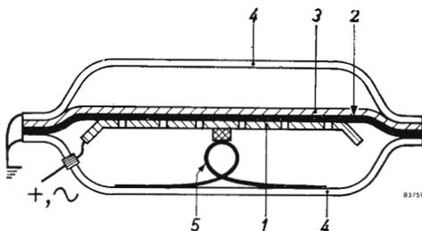
Fig. 75. Altoparlante elettrostatico:
