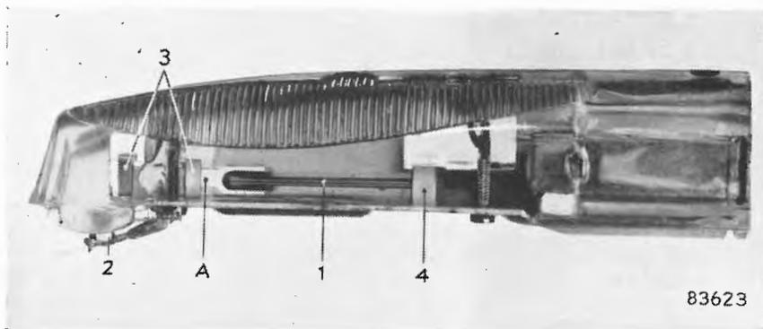
Fig. 18. Pick-up a cristallo tipo AG 3010.
