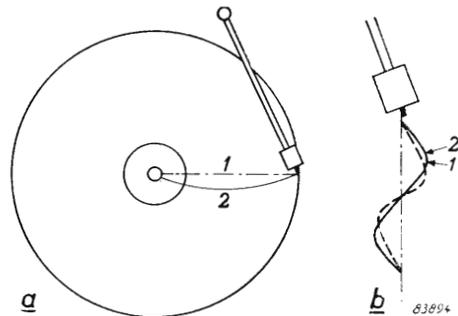
Fig. 32. La causa della distorsione di non tangenzialità.
