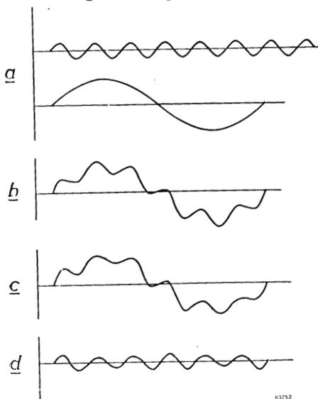
Fig. 57. Distorsione d'intermodulazione
