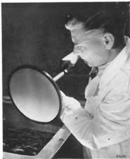
Fig. 14. Bagno galvanico per la formazione del « padre ».
