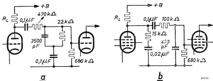
Fig. 60. Filtri per la correzione di riproduzione.
