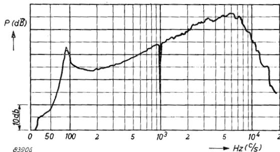
Fig. 79. Curva della pressione sonora dell'altoparlante tipo 9770.
